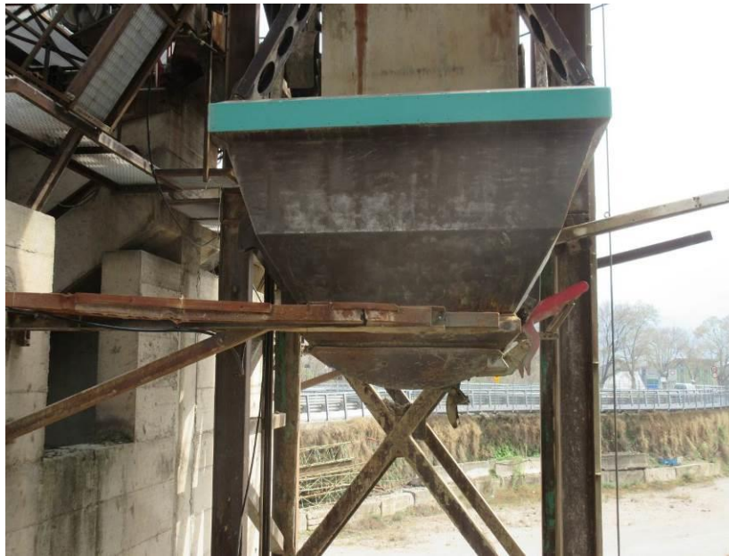
Figura 25: stazione di monte della teleferica (si noti il sistema di apertura della botola di fondo tramite la leva rossa)
