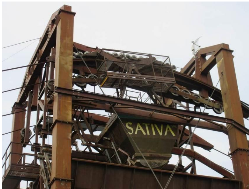
Figura 25: stazione di monte della teleferica (si noti il sistema di apertura della botola di fondo tramite la leva rossa)
