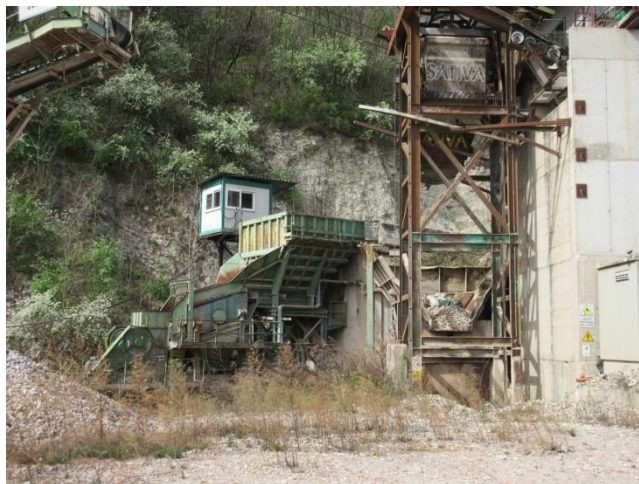
Figura 16: Particolare del sistema di frantumazione che verrà smantellato
