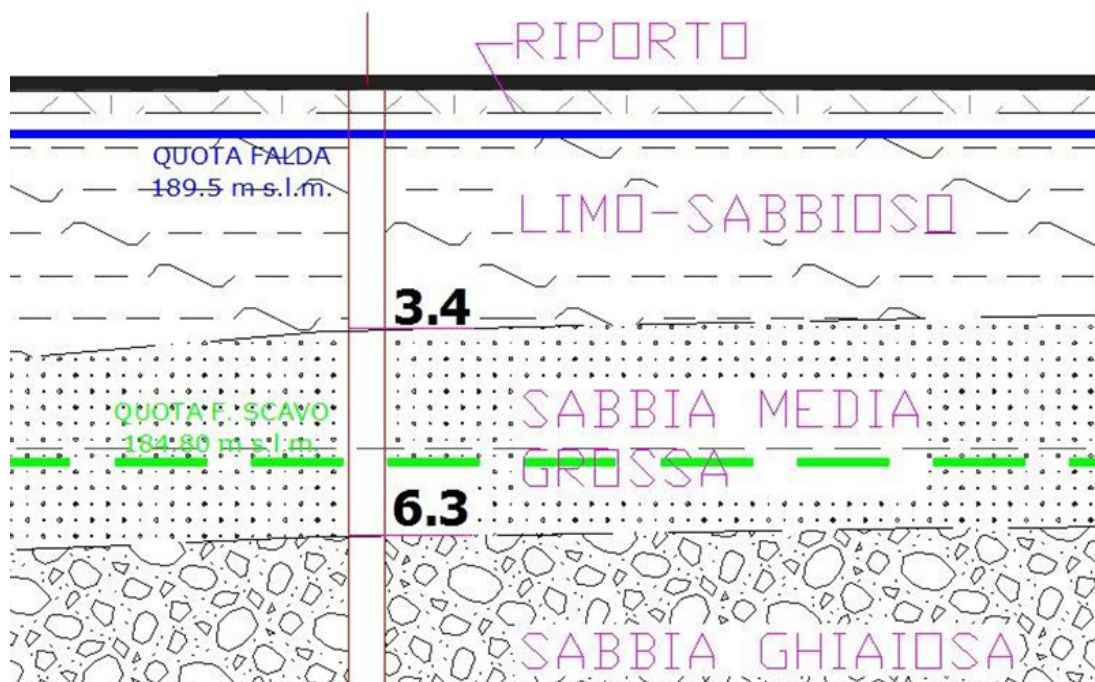
Figura 41: Sezione tipo, litotipi presenti nel sottosuolo tra p.c. e fondo scavo. (FONTE: Relazione geologica dott. geol. Cristiano Belloni – novembre 2019)
