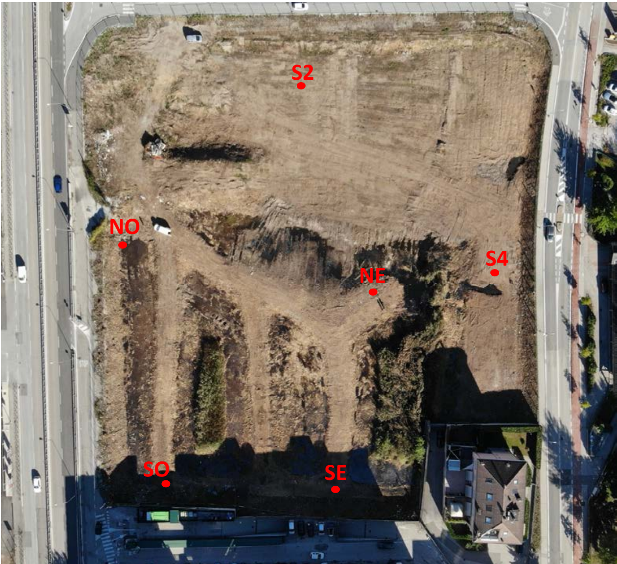
Figura 47: Planimetria del sito ex Opel Franceschi, con la posizione illustrativa dei piezometri oggetto di campionamento. (FONTE: Nuova Ecologia s.r.l.)
