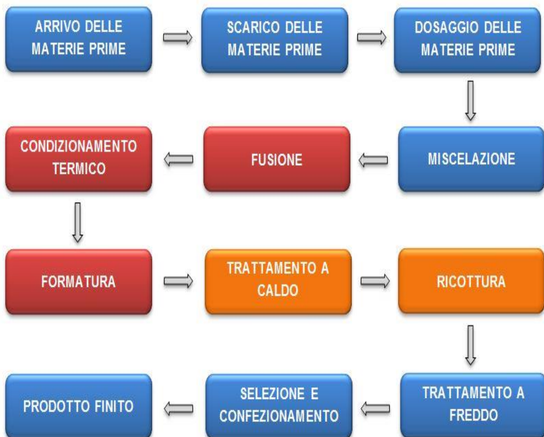
Schema 1: flow chart processo produttivo.
