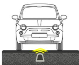
I sensori che si prevede di installare con il progetto Stardust per l'occupazione per il rilevamento dell'occupazione degli stalli a raso, partendo da quelli riservati a disabili e al carico e scarico di merci attorno al centro storico sono dispositivi da inserire sotto l'asfalto. Gli stessi dispositivi saranno utilizzati per il rilevamento degli stalli blu a pagamento previsti dal progetto C-Roads Italy 2.
