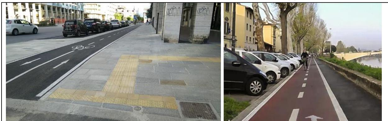
**percorsi promiscui pedonali e ciclabili** realizzati, di norma, all'interno di parchi o di zone a traffico prevalentemente pedonale, nel caso in cui l'ampiezza della carreggiata o la ridotta entità del traffico ciclistico non richiedano la realizzazione di specifiche piste
