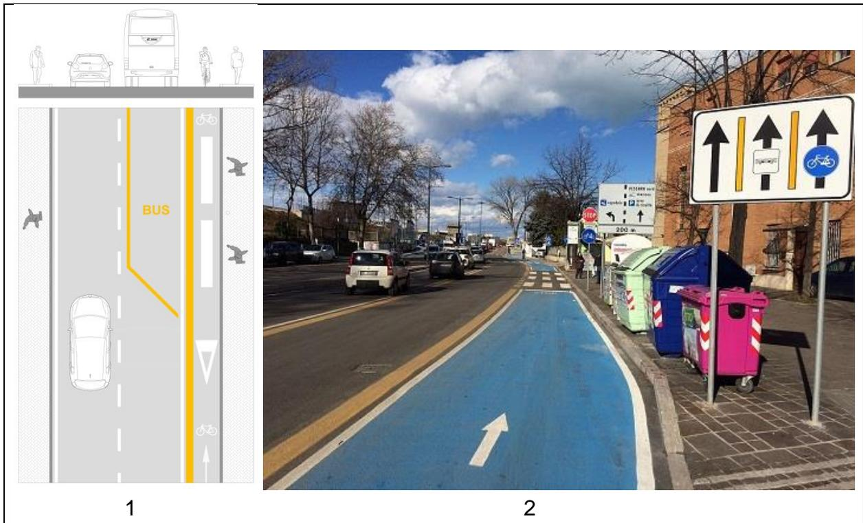
Lungo la pista ciclabile monodirezionale viene inserita un attraversamento pedonale con apposita striscia e il segnale triangolare che indica al ciclista di dare la precedenza ai pedoni (schema 1) o con la segnaletica orizzontale e verticale di Stop (foto 2, Pescara – via De Gasperi).
