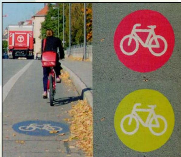
*Esempio di pitturazione a terra riprendendo la colorazione degli itinerari di progetto*
