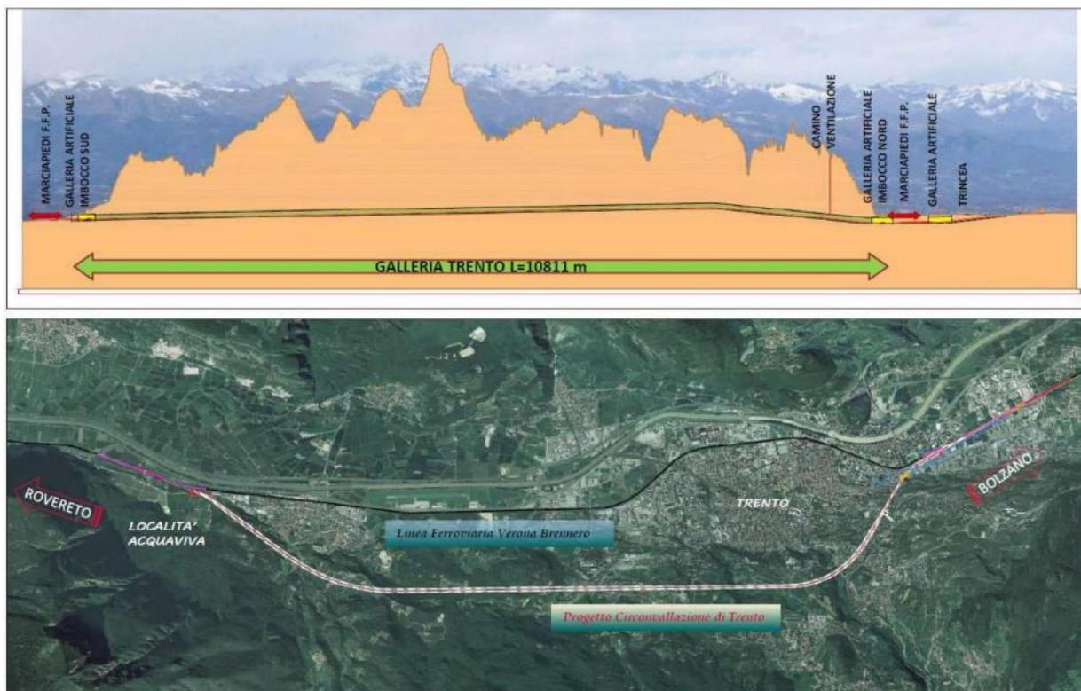
Il tracciato parte da scalo Filzi, si sviluppa in sotterraneo con galleria naturale di 11 km, e si ricollega alla linea storica all’altezza di Acquaviva. È una galleria a doppia canna, di raggio 4,20 m.
