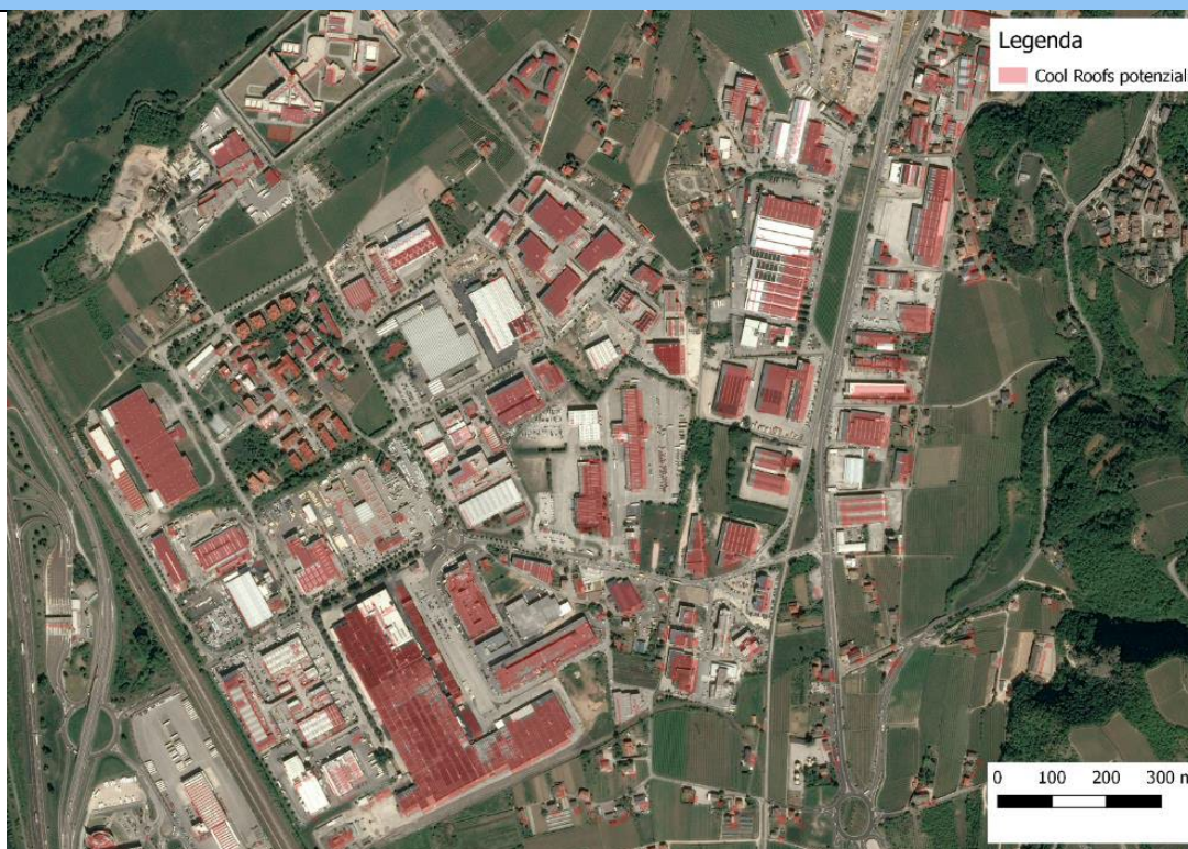
Immagine 25 Estratto della mappa riferita all'analisi cromatica delle coperture degli edifici, al fine di evidenziare le aree potenzialmente convertibili in cool roofs (da documento "Definizione delle misure di mitigazione e adattamento ai cambiamenti climatici" elaborato nell'ambito del Progetto Santa Chiara Open Lab"
