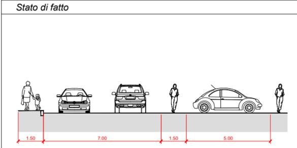
sezione A- via SOPRASASSO - scala 1:200
