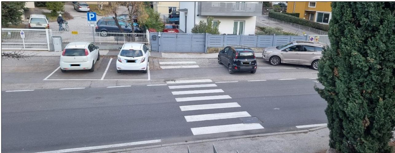
Per risolvere le criticità evidenziate, il progetto propone quindi lo spostamento a nord dell'attraversamento pedonale e l'ampliamento del marciapiede (5,00x2,50m), per creare uno spazio sicuro per i pedoni in attesa dell'attraversamento.
