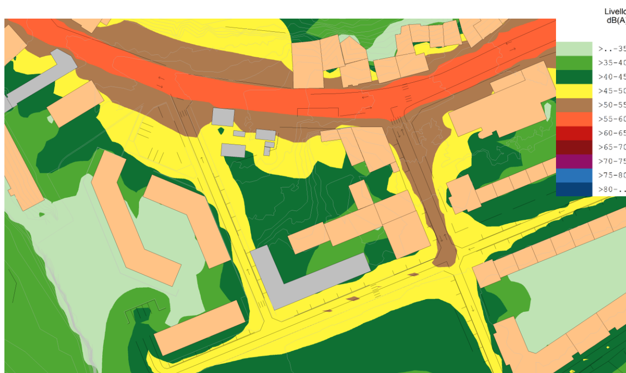
Figura 15: Mappatura acustica dei livelli di immissione nello "scenario di progetto" in periodo di riferimento notturno (22-6), calcolati ad un'altezza rispetto al terreno di 4 metri e in assenza del tomo nel modello 3D di riferimento.
