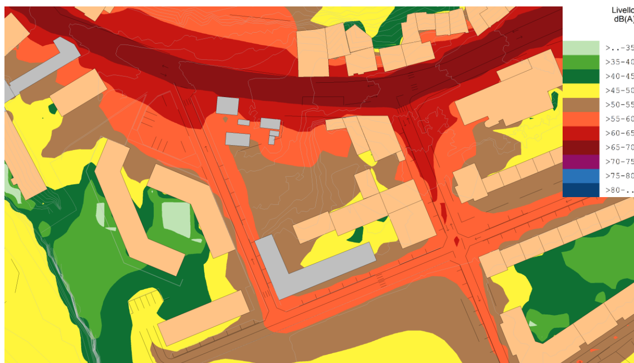
Figura 14: Mappatura acustica dei livelli di immissione nello "scenario di progetto" in periodo di riferimento diurno (6-22), calcolati ad un'altezza rispetto al terreno di 4 metri e in assenza del tomo nel modello 3D di riferimento.
