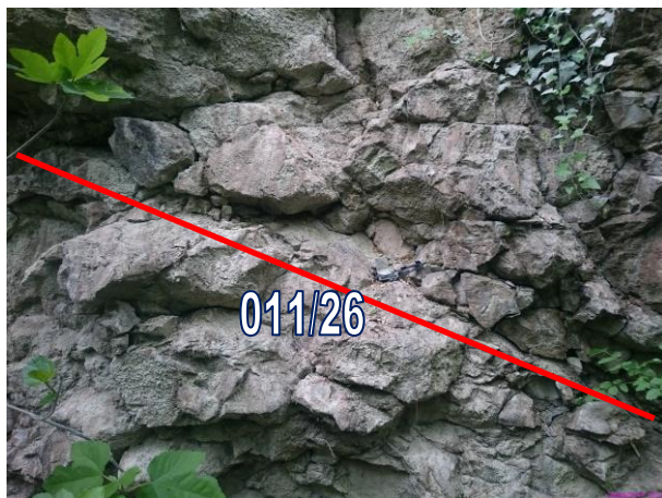
Giunti a basso angolo rilevati alla base della parete: 011/26 e 145/27.
