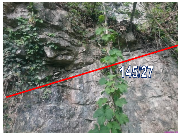
Giunti a basso angolo rilevati alla base della parete: 011/26 e 145/27.
