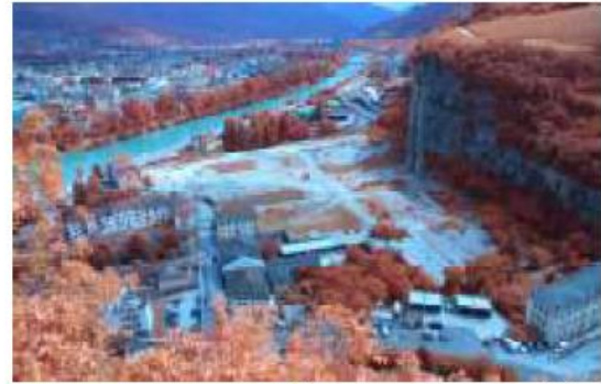
Fig. 3 - Esempi di riprese multi spettrali effettuate dal Doss Trento con camera modificata per essere sensibile nello spettro del blu, verde e primo infrarosso.
