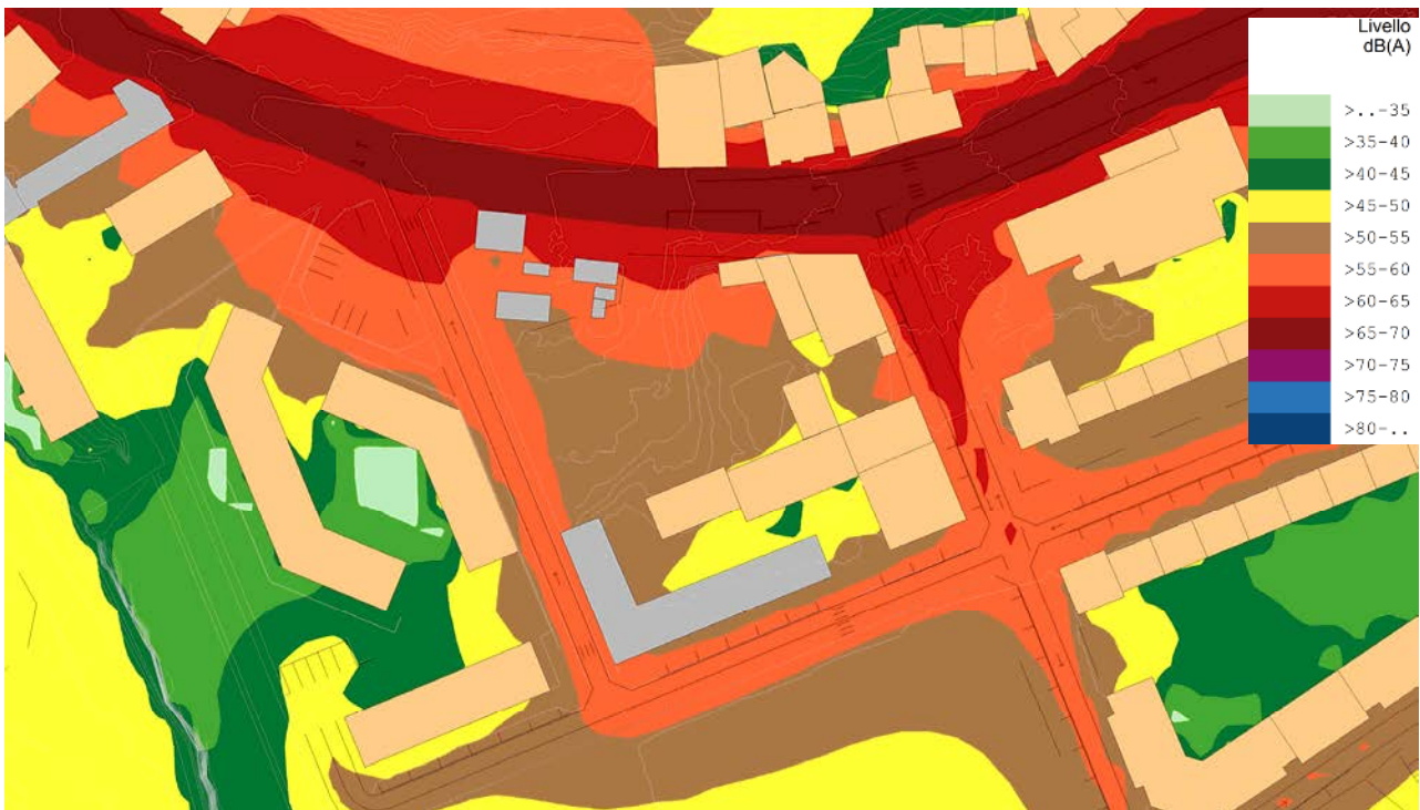
Figura 15: Mappatura acustica dei livelli di immissione di progetto in periodo di riferimento diurno (6-22).
