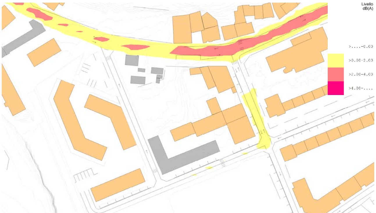
Figura 20: Mappatura del confronto con i limiti nello scenario di progetto in periodo di riferimento notturno.
