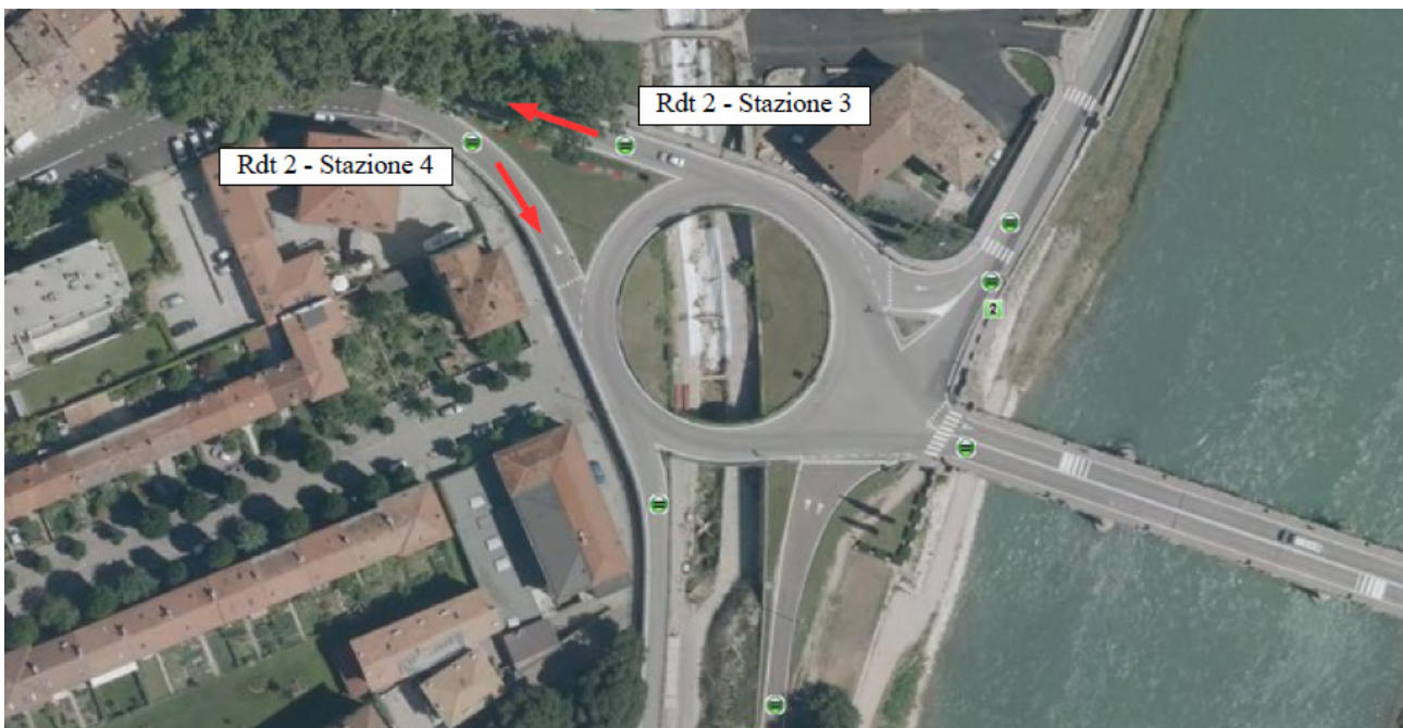
Figura 5: Inquadramento della postazione di rilevamento traffico n. 2 di via Brescia fornita dal Comune di Trento con indicata la posizione delle spire per il conteggio dei flussi veicolari.
