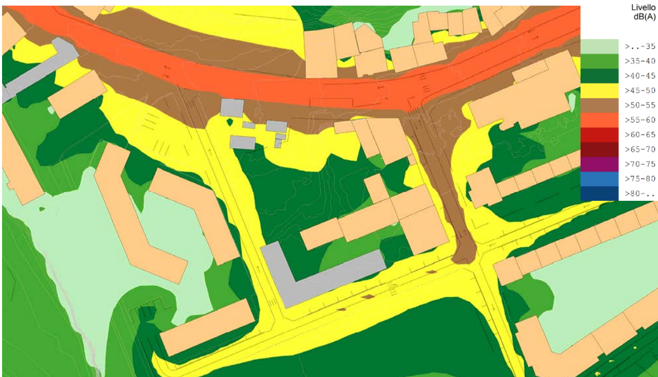
Figura 16: Mappatura acustica dei livelli di immissione di progetto in periodo di riferimento notturno (22-6).
