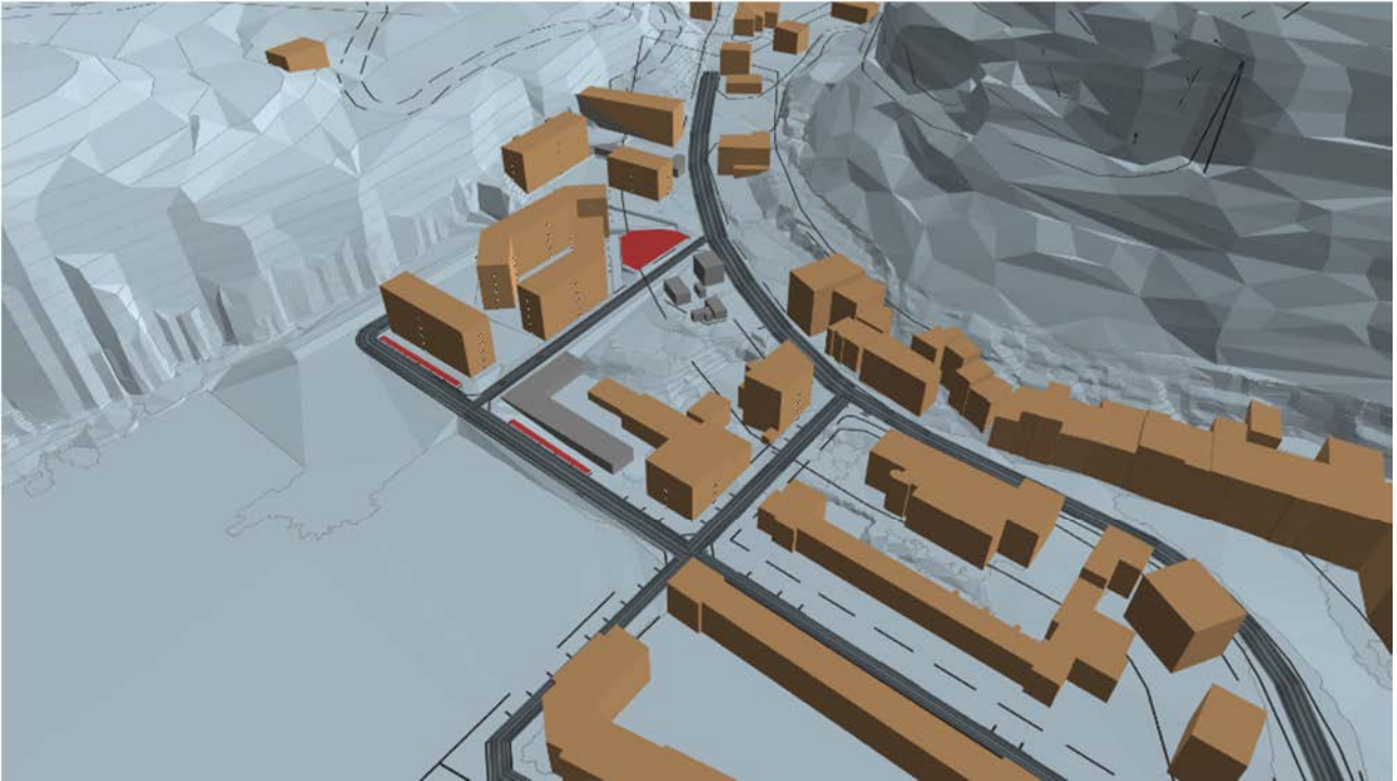
Figura 7: Immagine del modello tridimensionale del terreno per la modellazione del campo acustico. Stato di progetto: vista dall'alto del nuovo studentato con identificazione dei nuovi parcheggi.
