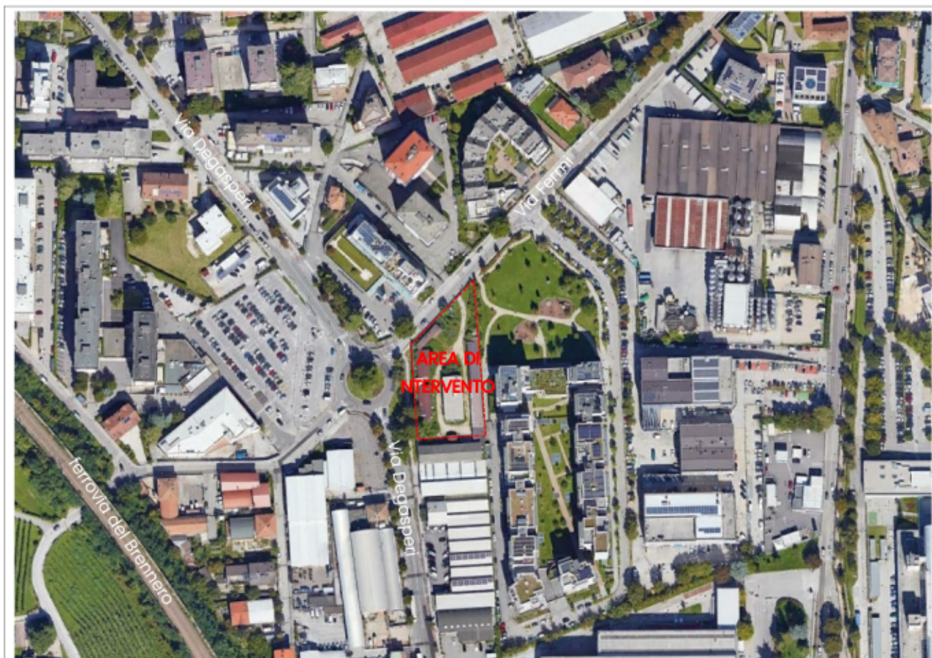
Figura 1: Inquadramento generale dell'area oggetto di indagine, con identificazione degli elementi di interesse per lo studio previsionale di clima acustico. In particolare, essi consistono nella viabilità locale di via Fermi e via Degasperi, che lambiscono il lotto di intervento e nella ferrovia del Brennero, a una distanza di circa 200 m. Le aree circostanti sono caratterizzate da insediamenti misti residenziali e commerciali.
