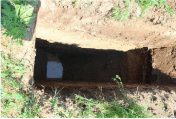
Foto 2.4 e 2.5: la trincea 2 con la falda al contatto del terreno B ed il materiale A grossolano.
