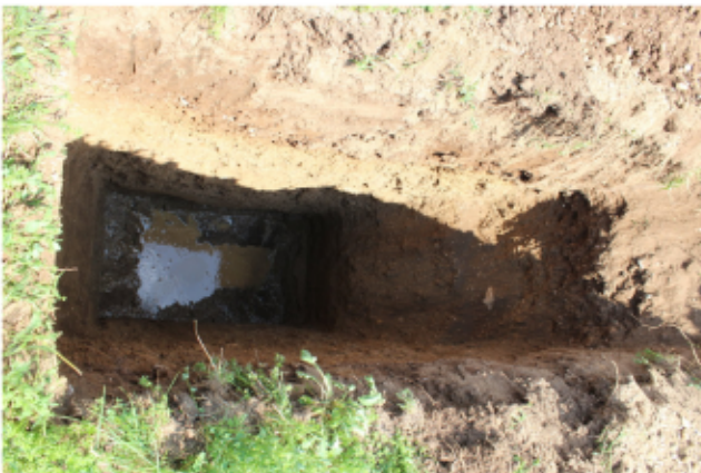
Foto 2.6 e 2.7: la trincea 3 con la falda al contatto del terreno B ed il materiale A grossolano.
