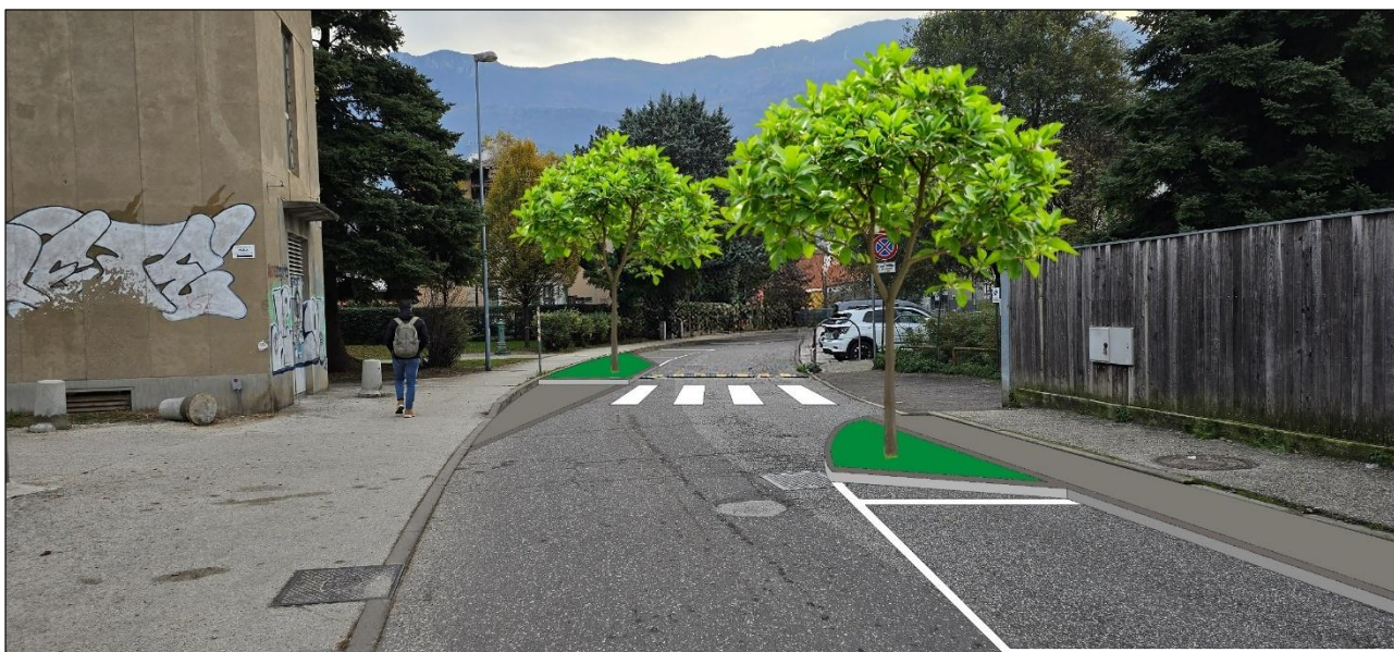
via Einaudi in corrispondenza del civico 21: proposte di progetto con chicane per la moderazione delle velocità, nuove aiuole alberate e nuovo attraversamento pedonale e ciclabile
