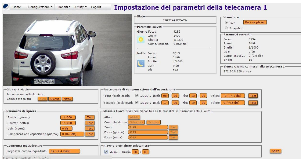
Figura 114 - Impostazione parametri telecamera Vista EnVES03
