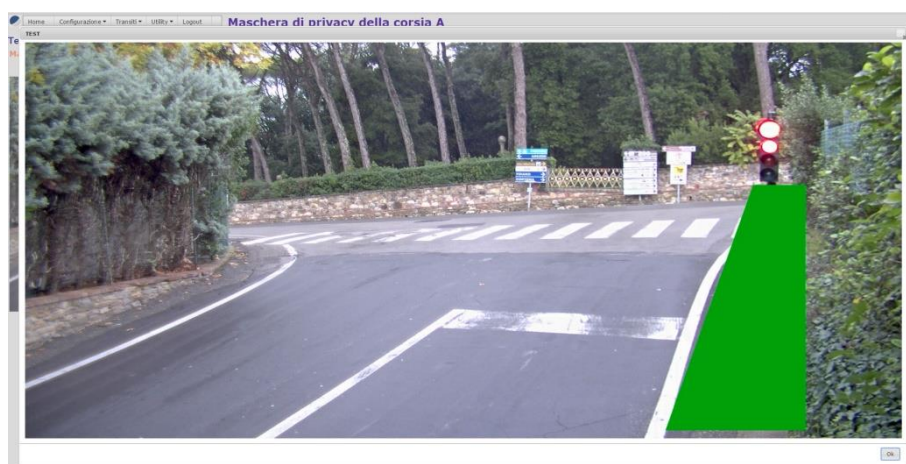
Figura 126 - Test aree di privacy nel caso di una maschera a colore uniforme verde
