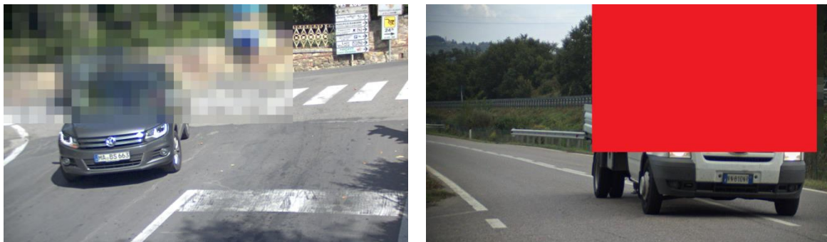
Figura 9 - Mascheramento con pixelize (a sinistra) e con maschera uniforme (a destra)
