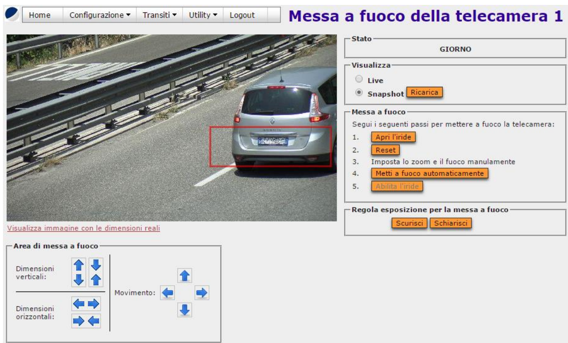
Figura 124 - Procedura di messa a fuoco Vista EnVES06
