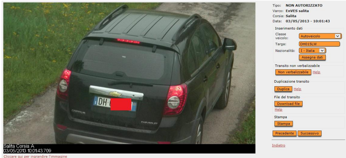
Figura 20 - pagina di verifica del corretto riconoscimento della targa
