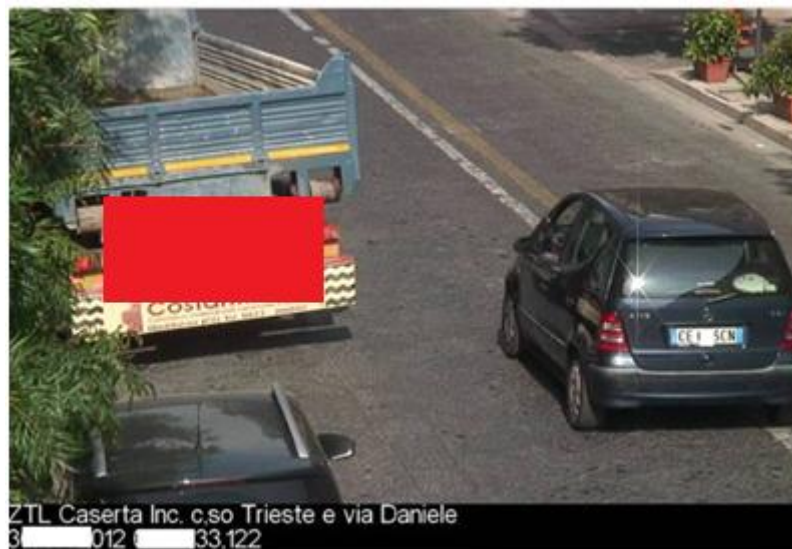
Figura 22 – privacy zone che copre la targa di un veicolo non in infrazione
