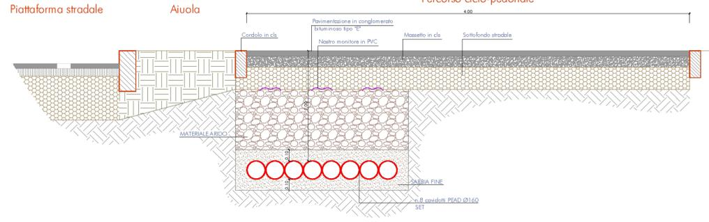
SEZIONE TIPO POSA CAVIDOTTI SET - VIA STELLA DI MAN
