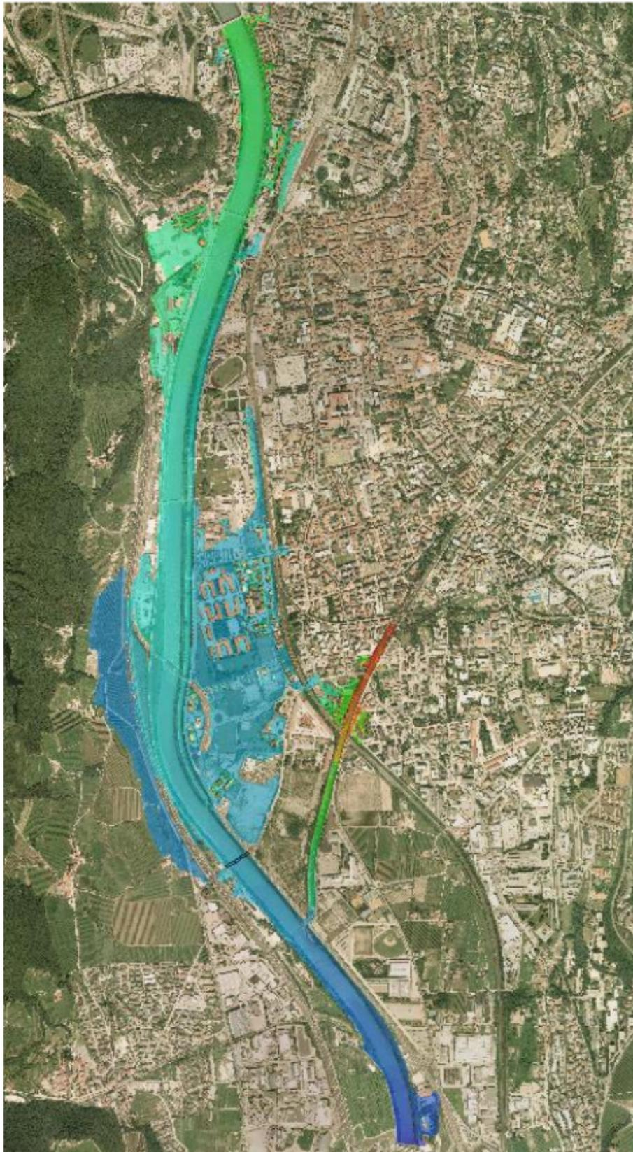
Figura 24. Aree di esondazione per la simulazione con  $T_r$  200 anni e scabrezza alvei Adige pari a  $K_s = 37 \text{ m}^{1/3}/\text{s}$ .
