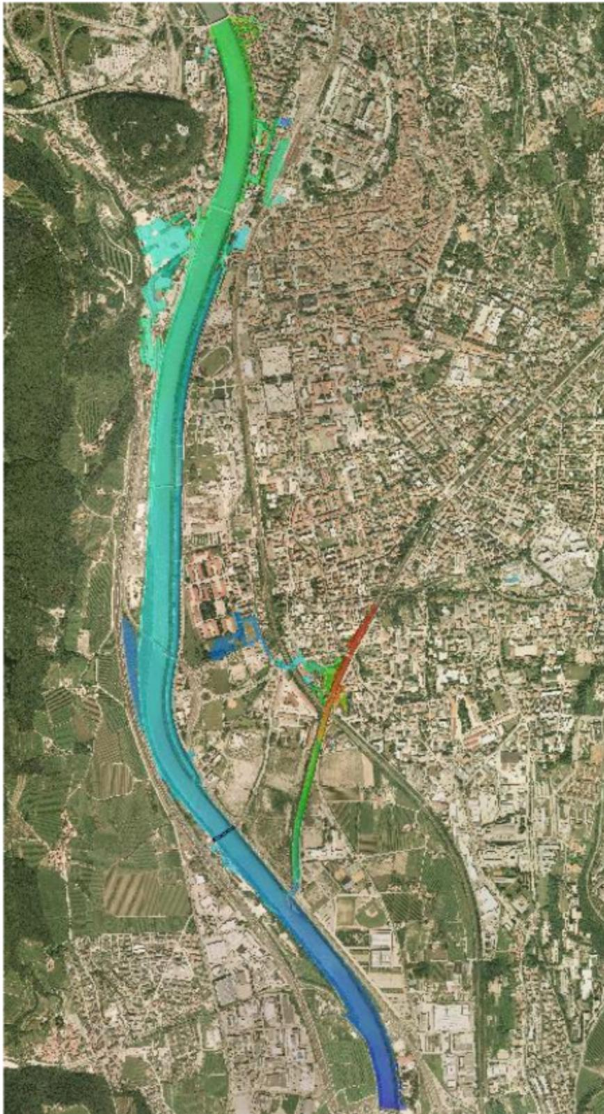
Figura 25. Aree di esondazione per la simulazione con  $T_r$  100 anni e scabrezza alvei Adige pari a  $K_s = 37 \text{ m}^{1/3}/\text{s}$ .
