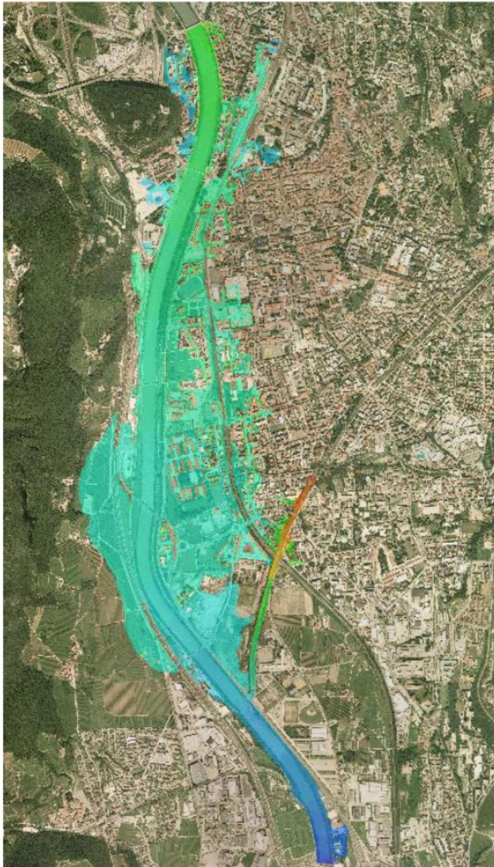
Figura 19. Aree di esondazione per la simulazione con  $T_r$  200 anni e scabrezza alvei Adige pari a  $K_s = 30 \text{ m}^{1/3}/\text{s}$ .
