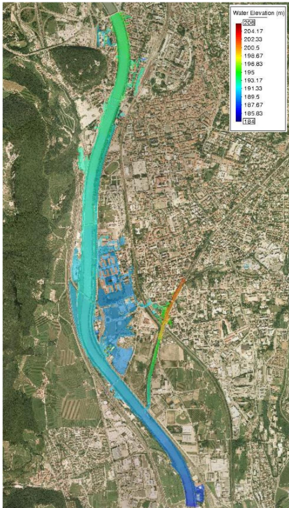
Figura 16. Aree di esondazione per la simulazione con  $T_r$  100 anni e scabrezza alvei Adige pari a  $K_s = 33 \text{ m}^{1/3}/\text{s}$ .
