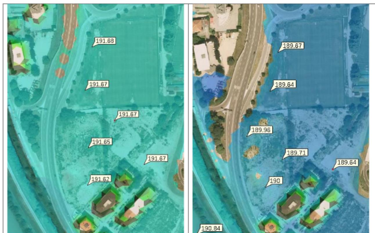
Figura 17. Quote massime assolute in m smm raggiunte dal tirante idrico nell'areale a monte di via Pezcoller per le piene con Tr 200 anni (a sinistra) e Tr 100 anni (a destra).
